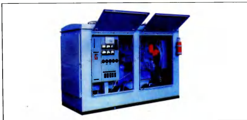
Рис. 6. Дизельная электростанция АД-30 ОАО «Рыбинские моторы» (мощность 30 кВт; напряжение 400 В; частота тока 50 Гц)
